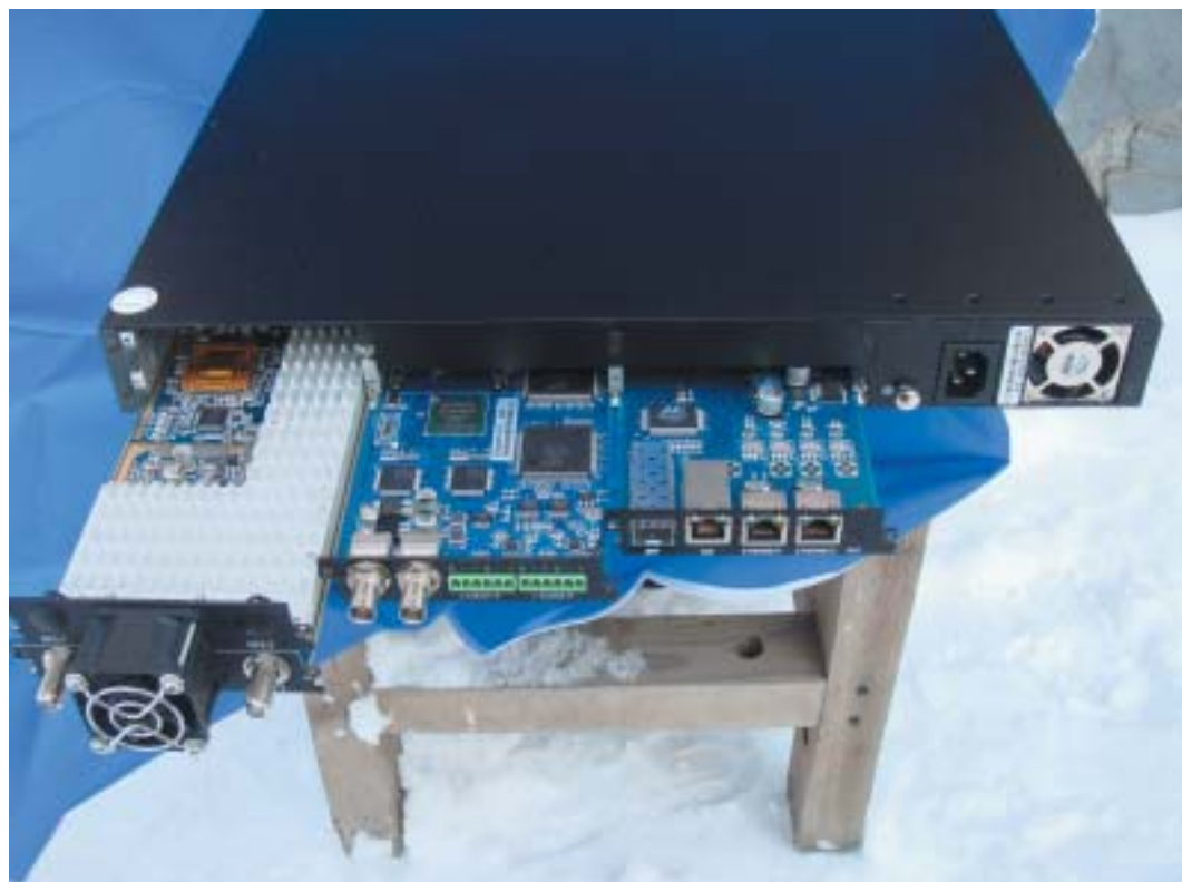
Рис. 3. Установка модулей в шасси EMR
